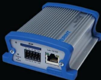
Nextiva inteligentni jednoportni encoderi omogućuju dvostruki prijenos (dual stream) MPEG4/MJPEG slike, sa opcijskim napajanjem preko etherneta (PoE) i integriranim analitikom. Svi Nextiva jednoportni uređaji uključuju RS-422/485 serijsku vezu za PTZ podršku, jedan alarmni ulaz i jedan alarmni izlaz, SSL autentifikaciju, filter za redukciju šuma, bi-direkcijski zvuk, te opciju rada u proširenom temperturnom području.
